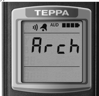
Рисунок 8 – РКІ дозиметра (початок підрежиму збереження результату вимірювання в енергонезалежній пам'яті)
